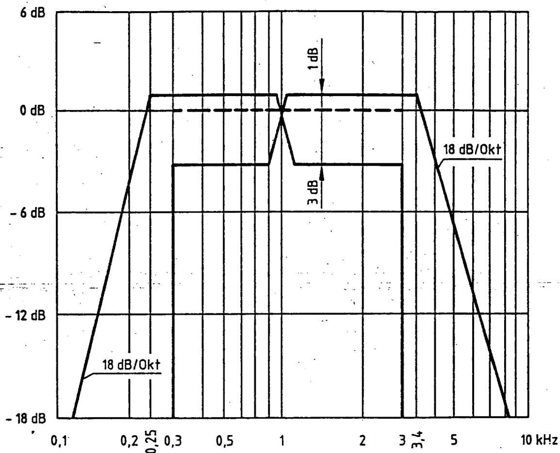
Bild 6.1 NF-Frequenzgang des Empfängers
